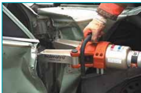
Separando una puerta de un vehículo
