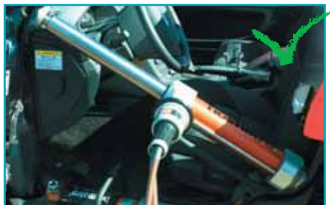
Corte antes para facilitar la separación
