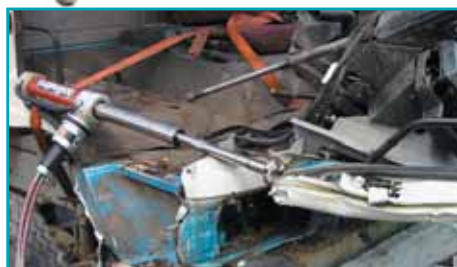
Cilindro telescópico totalmente extendido
