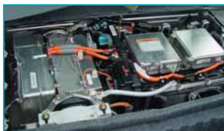
Sistema de baterías del Honda "Insight"
