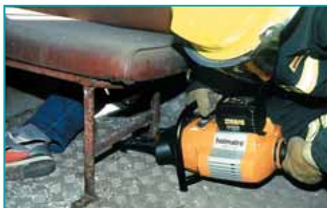
Las herramientas de rescate autónomas trabajan bien en espacios confinados de un autobús.
