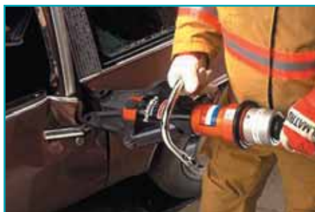
Separando una puerta de un vehículo
