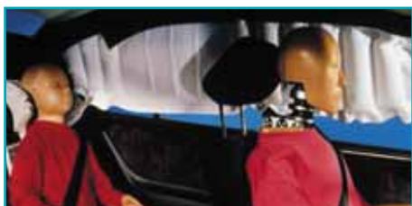
Sistema de airbag tipo cortina inflable
