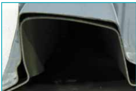
Sección de un Poste B modelo 1996
