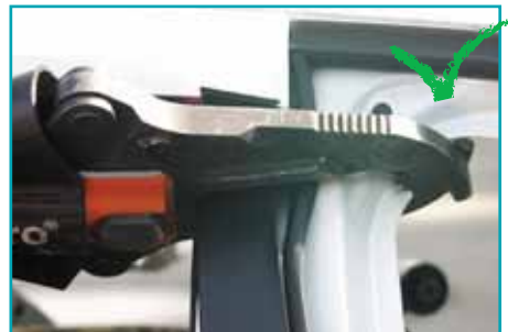
Evite cortar con las puntas
