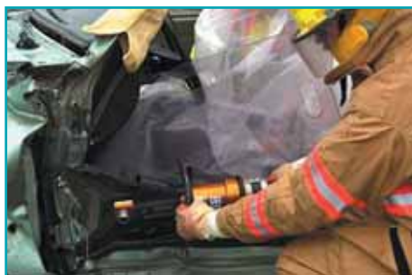
Levantando el tablero con un multiuso
