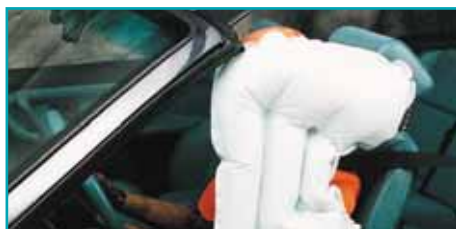
Bolsa de aire para impacto lateral colocada en el asiento
