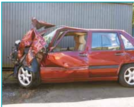
Deformación debido a las zonas de absorción de impactos
