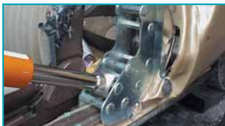
Soporte del cilindro que actúa como un punto estable.
