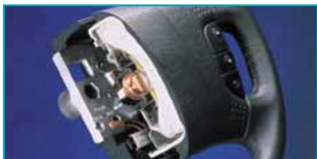
Sección de airbag frontal sin activarse
