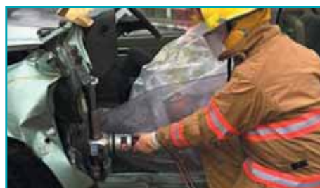
Levantamiento del tablero con un cilindro
