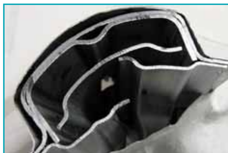
Sección de un Poste B modelo 2002
